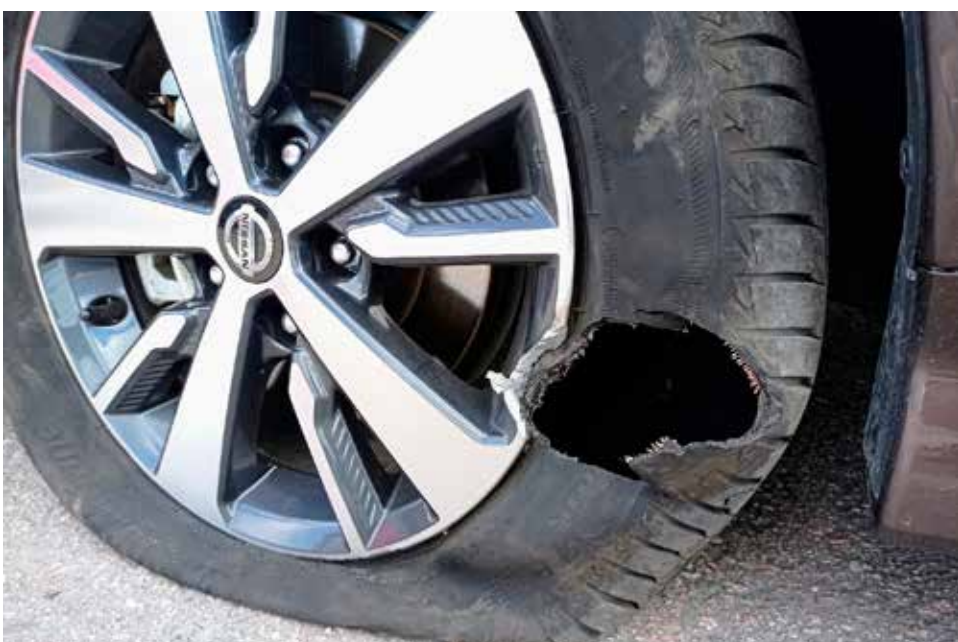
➤ Tyypillinen vaurio teräväreunaiseen kuoppaan ajamisesta. Isku on ollut kova ja vahingot tuskin rajoittuvat vain pyörään.
