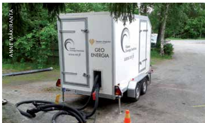
Vaasassa rakennettu mittausvaunu geoenergiakaivojen tutkimiseen.
