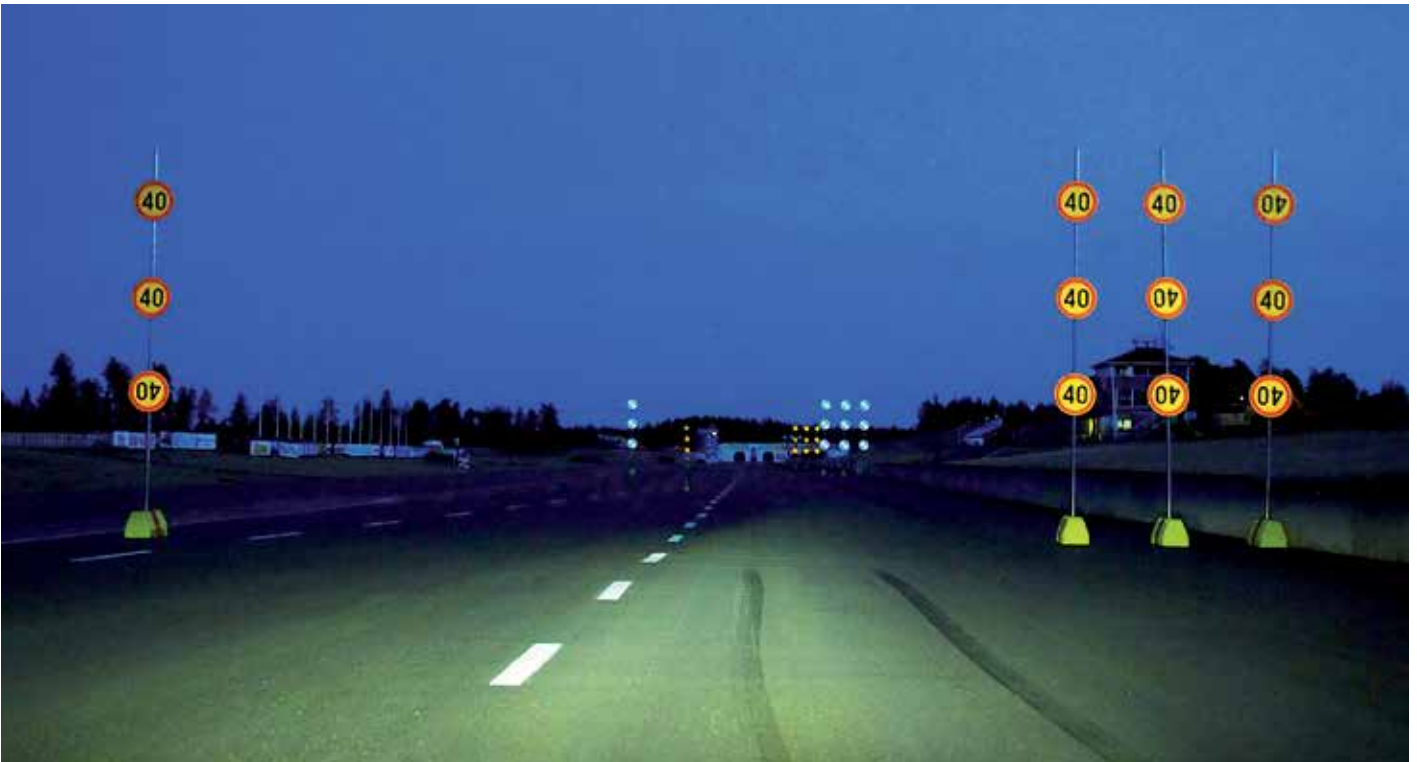
Koekentän rakenne ja havainnointitilanne autosta kuvattuna. Koetilanteessa oli todellisuudessa pimeämpää.
