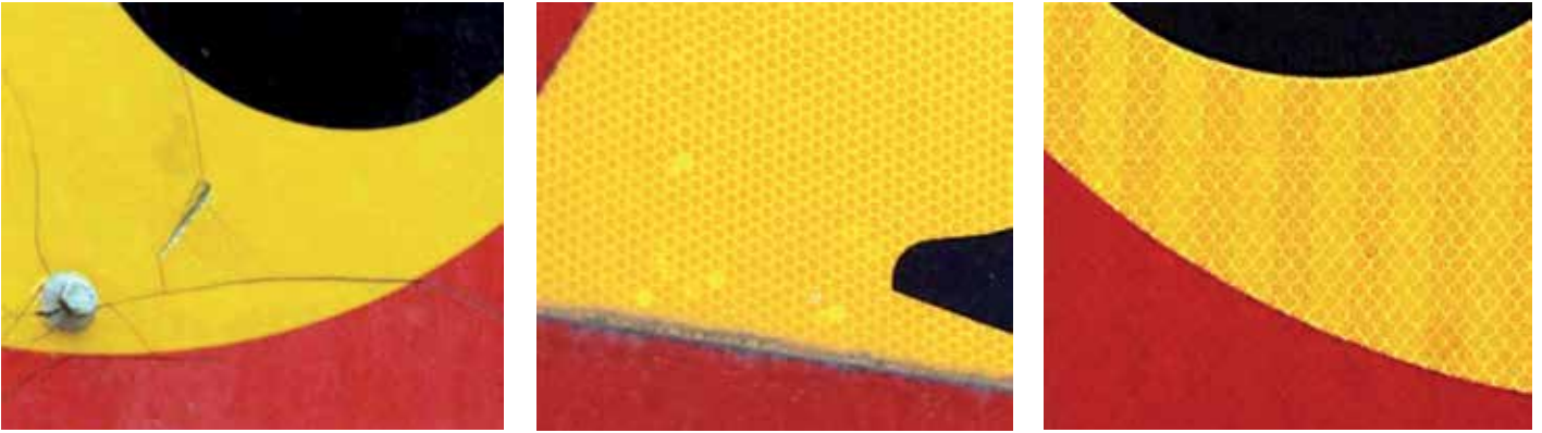
Esimerkkejä liikennemerkkien materiaaleista. Vasemmalla R1-luokan lasihelmikalvo, keskellä R2 lasihelmi ja oikealla R2 prisma.
