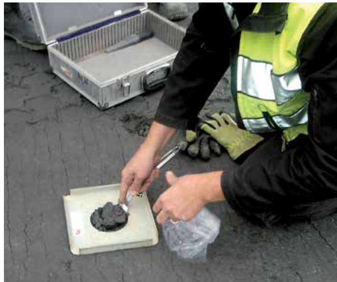
Volymetrimittaus tiivistetystä kivihiilituhkapenkereestä.
