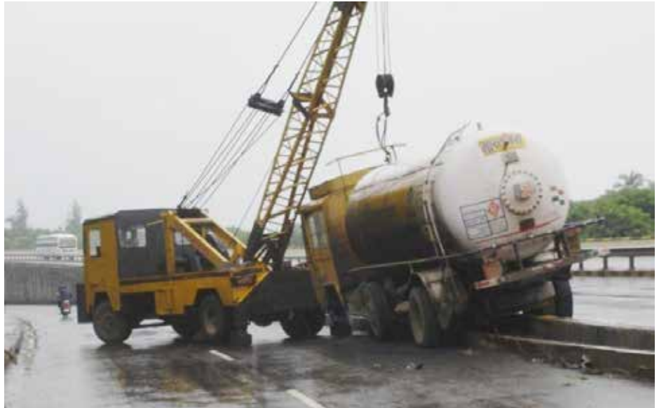
Korkean keskisaarekkeen kaappaama säiliöauto Intiassa. Maan tapa on ollut rakentaa moottoreille korotettu keskisaareke, jonka reunakivi on 30–40 cm maanpinnasta.
