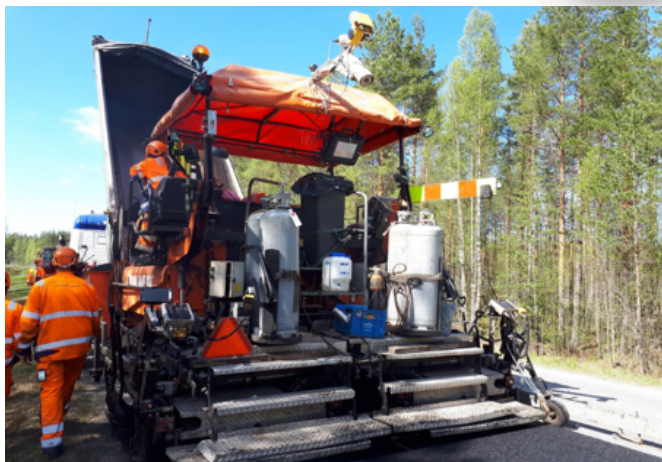
Moba IR Scanner - Lemminkäinen Infra Oy:n digipilotointi
