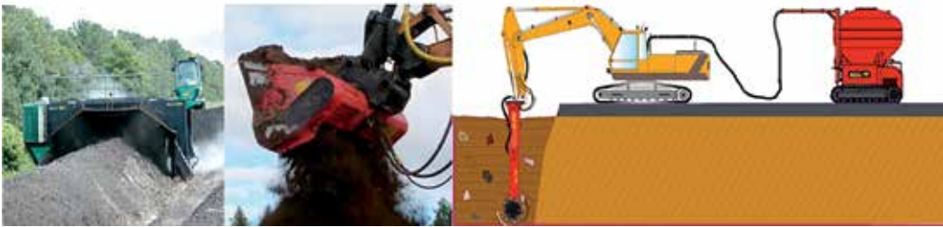
Uusiomateriaalien sekoitukseen soveltuvia sekoittimia: aumasekoitin, seulakauha ja massastabilointilaitteisto.
