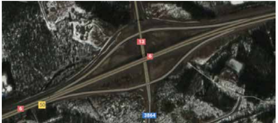
Kuva 1. Esimerkki perusverkon eritasoliittymästä: rombinen eritasoliittymä teiden 6 ja 13 välinen liittymä (Google Maps).
