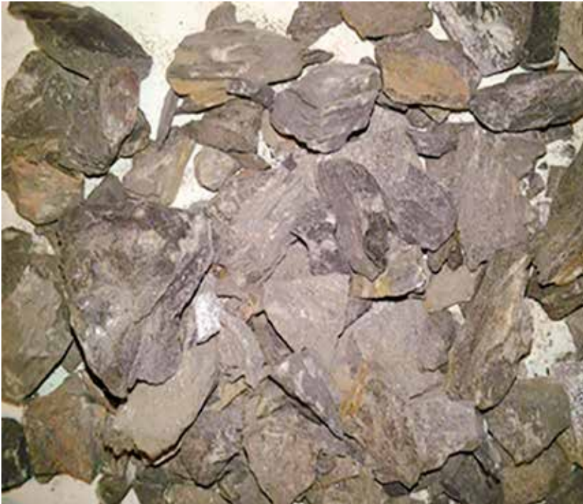
Kuva 4. Kiviaines, jonka iskukestävyys täyttää asetetun vaatimuksen, mutta hiovan kulutuksen kesto on huono eli kiviaines hienonee kosteissa olosuhteissa jo rakentamisen aikana.
