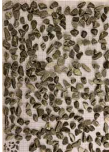
Kuva 3. a) Kiviaines kuulamylytystin jälkeen, kun alkuperäisen materiaalin litteysluku on 32, testin tulos 12,8 b) Kiviaines kuulamylytystin jälkeen, kun alkuperäisen materiaalin litteysluku on 0, testin tulos 6,5. (kuva Niko Hietala 2019)
