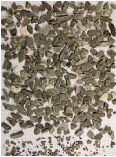
Kuva 3. a) Kiviaines kuulamylytystin jälkeen, kun alkuperäisen materiaalin litteysluku on 32, testin tulos 12,8 b) Kiviaines kuulamylytystin jälkeen, kun alkuperäisen materiaalin litteysluku on 0, testin tulos 6,5. (kuva Niko Hietala 2019)
