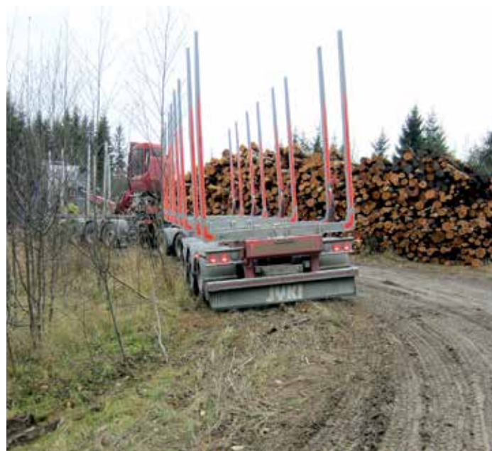
Pidentyneet akselivälit puunkuljetusautoissa aiheuttavat nykyisillä kääntöpaikoilla perävaunun oikaisua, joka saattaa pehmentää maan ajo- ja lastauskelvottomaksi.
