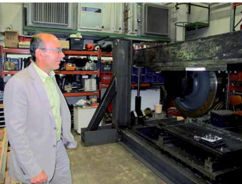
Maa- ja pohjarakenteet -yksikössä laboratorio- ja kenttätutkimukset ovat olennainen osa yliopistollista toimintaa. Ratatarkon vierintäväsytymisen tutkimiseen on rakenteilla uusi testilaitteisto.
