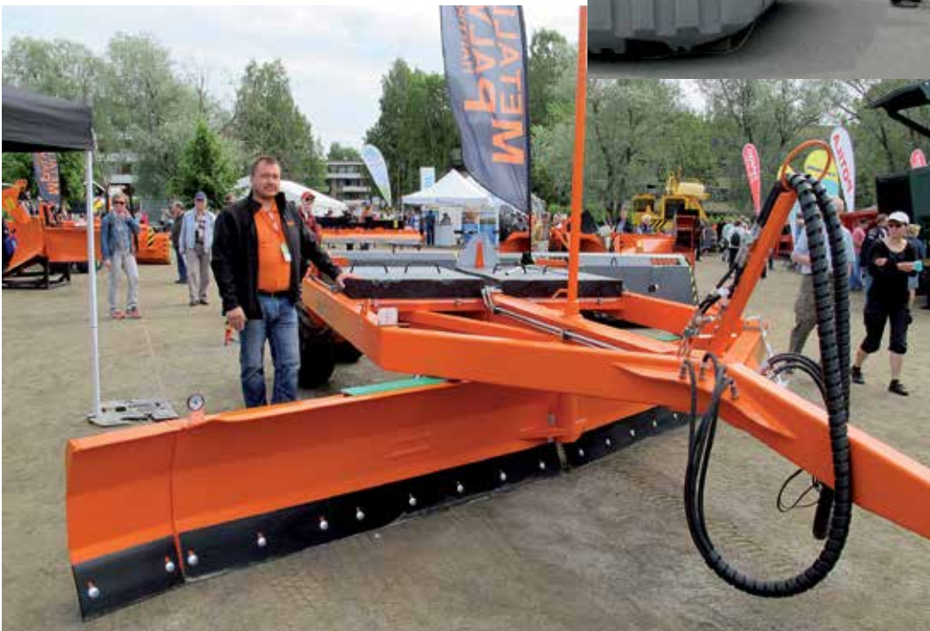
Peltojen lanaukseen tarkoitettu MpH-lanalla onnistuu myös teiden tasaus. Työlevyettä saadaan tarvitta- essa reilusti yli 5 m.
