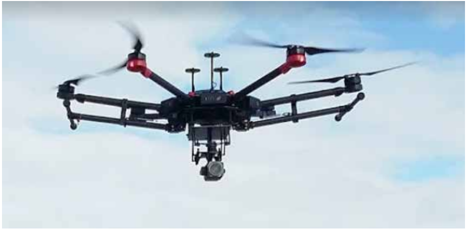
Keskitasen drone varustettuna kameralla ja erilaisilla mittauslaitteilla (kopterimalli).
