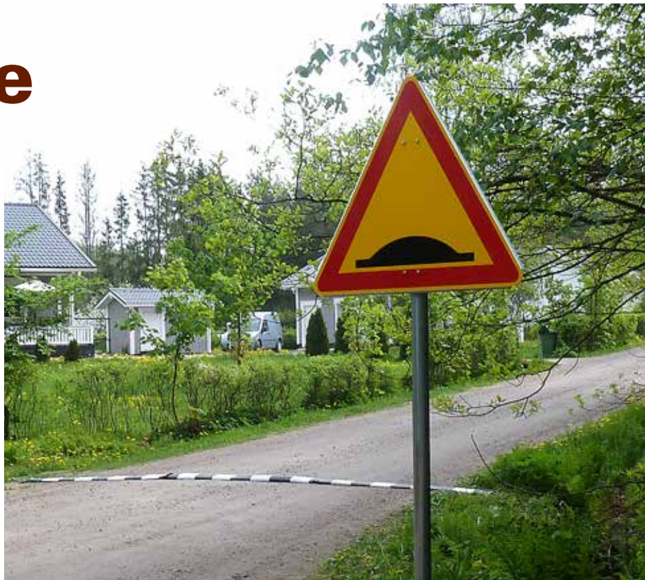
Hidastevyö on pingotettu paikalleen tien alittavan rummun kautta kulkevalla kiristysliinalla. Hidasteen edessä on töyssystä varoittava liikennemerkki
