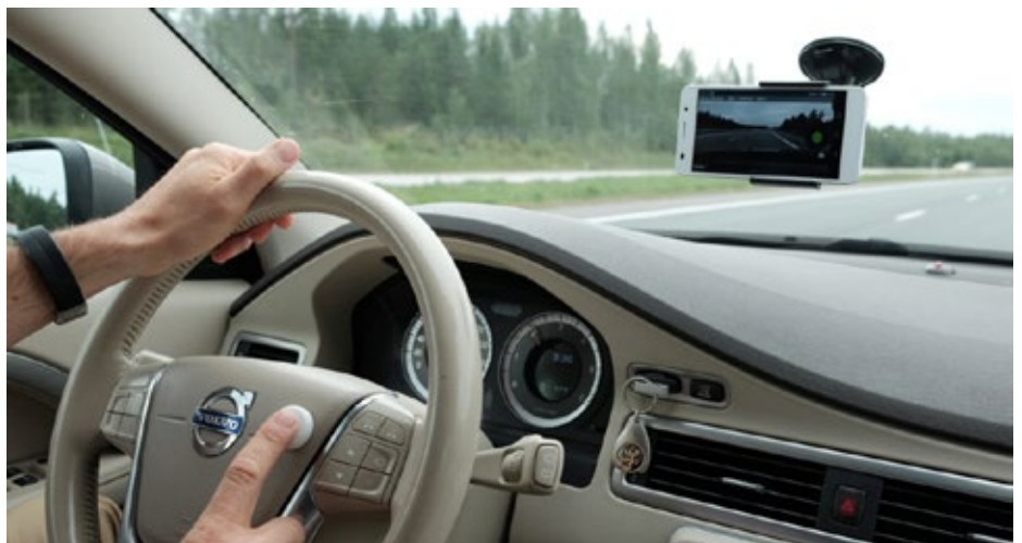
Pilotissa tietotietoa kerättiin ajoneuvojen tuulilaseihin kiinnitetyillä matkapuhelimilla ja painonapeilla.
