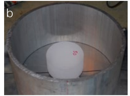
Kuva 3: a) Onteloresonaattori, jonka on vieressä tutkittava näyte ohuessa paperikauluksessa. Resonaattorin kuori on kuparilevyä, jonka saumat on kiinnitetty johtavalla liimalla. b) Osittain täytetty resonaattori, jossa on kalibrointikappale POM-muovista. Pohja ja putkimaiset vaipat ovat alumiiniseosta, kansi (ei kuvassa) on kuparia. Tutkittava näyte on onton solumuovijalustan päällä sylinterin keskellä.
