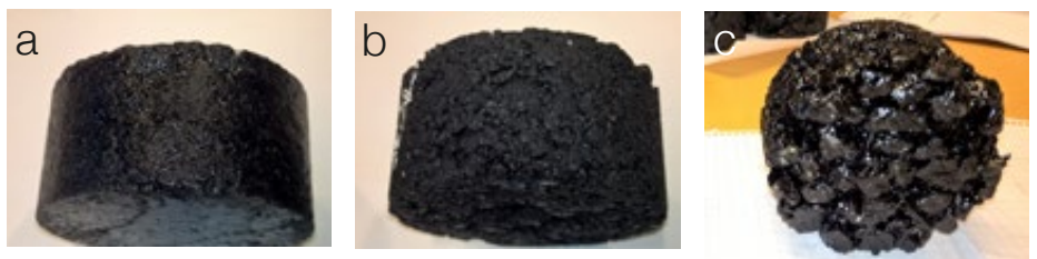
Kuva 2: Valokuvat asfalttibetoni a) AB/115, b) kivimastixiasfaltti SMA/800 ja c) avoin asfaltti AA/59 koekappaleista, jotka oli tiivistetty kiertotiivistimellä 115, 800 ja 59 kierroksella.
