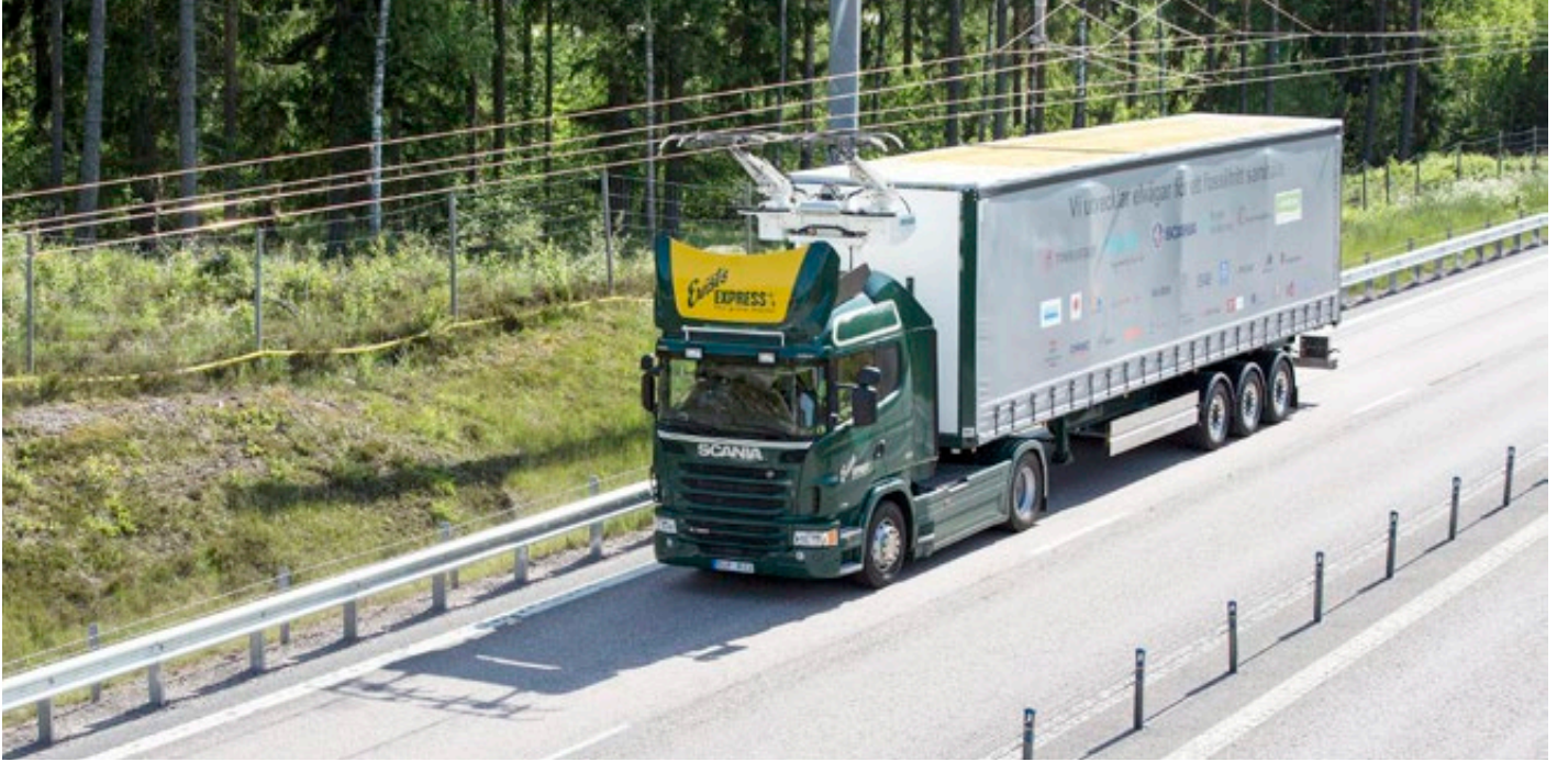
Scania G 360-sähköhybridikuorma-auto ajaa E16-valtatien sähköistettyä koeosuutta lähellä Gävlen kaupunkia. Kuva Scania AB.
