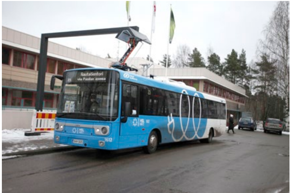
Kotimaista valmistetta oleva Linkker-sähköbussi pikalataa HSL-linjan 23 päätepysäkillä Invalidisäätiön rakennuksen vieressä. Kuva HSL.
