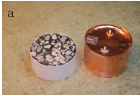
Kuva 3: a) Onteloresonaattori, jonka on vieressä tutkittava näyte ohuessa paperikauluksessa. Resonaattorin kuori on kuparilevyä, jonka saumat on kiinnitetty johtavalla liimalla. b) Osittain täytetty resonaattori, jossa on kalibrointikappale POM-muovista. Pohja ja putkimaiset vaipat ovat alumiiniseosta, kansi (ei kuvassa) on kuparia. Tutkittava näyte on onton solumuovijalustan päällä sylinterin keskellä.
