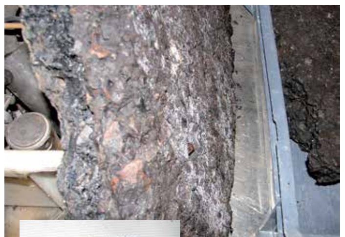
Kuva 3. Kehä II: Laattana irronnutta pinta-asfalttia, jossa on jäänmuodostusta laatan alla. Oikealla poranäytteitä, joissa liiman puuttuminen kerrosten välistä on aiheuttanut useampien kerrosten irtoamisen.
