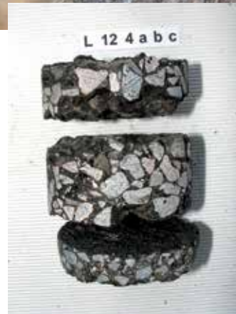
Kuva 3. Kehä II: Laattana irronnutta pinta-asfalttia, jossa on jäänmuodostusta laatan alla. Oikealla poranäytteitä, joissa liiman puuttuminen kerrosten välistä on aiheuttanut useampien kerrosten irtoamisen.
