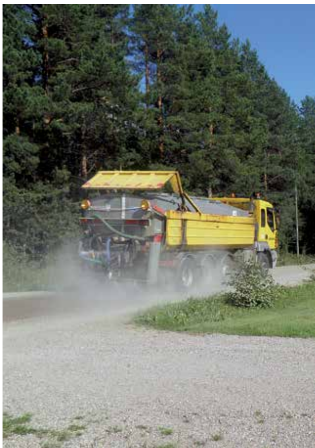
Valmis liuossuola levitetään tyhjennyslaitteella varustetusta säiliöstä yleensä urakoitsijan kuorma-autolla. Suolausauton itse aiheuttamasta pölystä päättellen suolaus tulee tarpeeseen.
