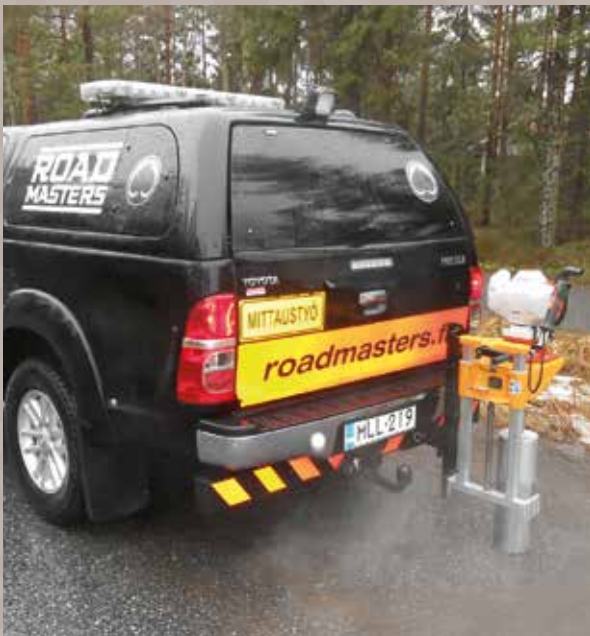
Päällystepora on asennettu Toyota Hiluxin perään. Poran asennus ja liikuttelu on nopeaa.
