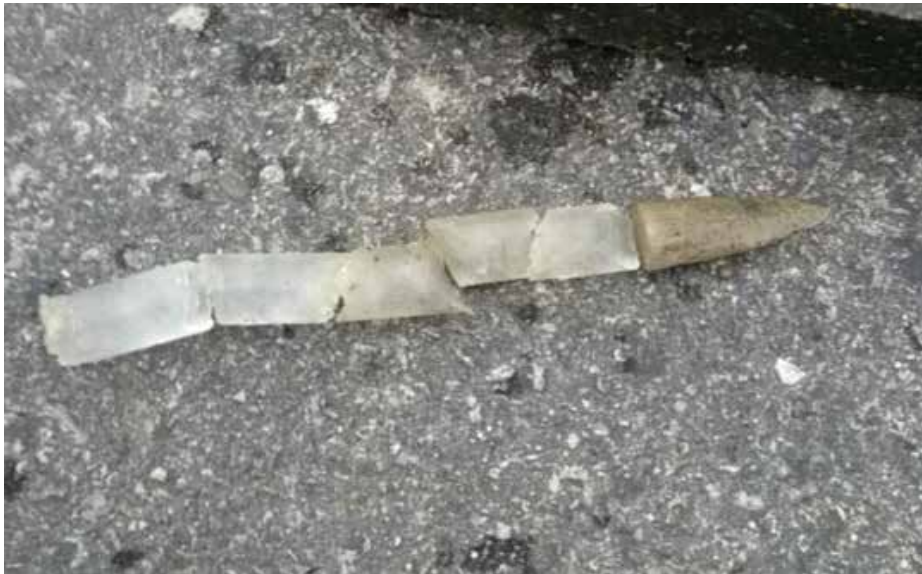
Peeran kohdan ikeiroudasta saatiin varmuus porakonekairauksella. Näyte osoittaa, että tien alla on kirkasta jäätä.
