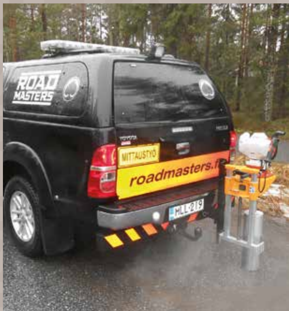
Päällystepora on asennettu Toyota Hiluxin perään. Poran asennus ja liikuttelu on nopeaa.
