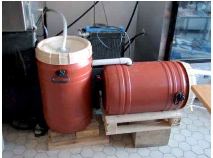
Vasemmalla puhdistettu SRK-laite ennen ajoja ja oikealla sedimenttitankit irtoavan materiaalin keräystä varten.
