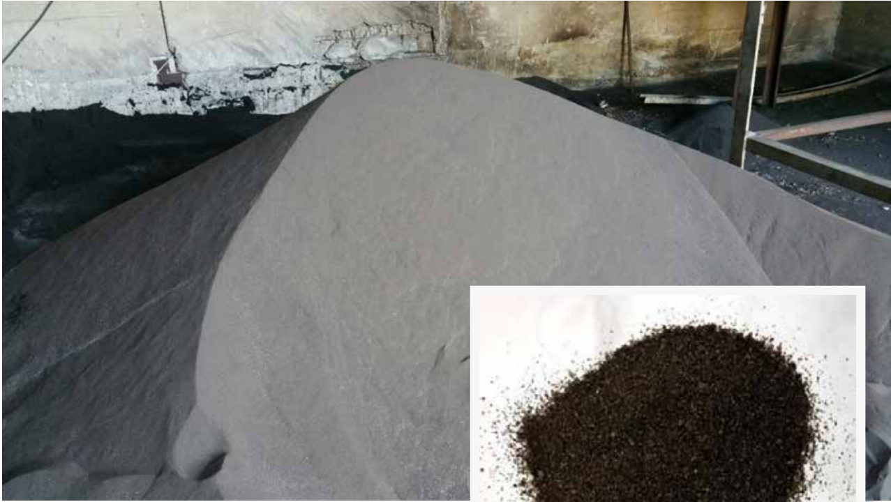
Kuvat rakeisesta uusiomateriaaliksi luokiteltavasta valimohiekasta.
