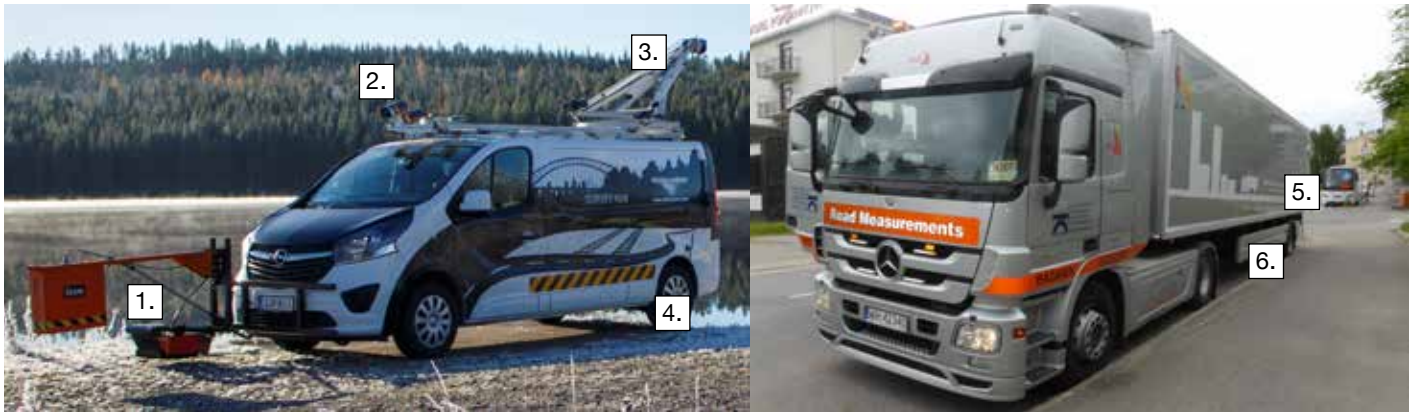
Kuva 2. PEHKO-tiestön toiminnallisen ja rakenteellisen kunnan mittaukset suoritettiin Roadscannersin kehittämällä RDSV-kalustolla (vasen kuva) ja tanskalaisen Greenwoodin kehittämällä TSD-kalustolla. RDSV kalusto koostuu maatutkasta (1), digitaalisista videokameroista (2), tien ja sen ympäristön poikkileikkauksen mittaamisesta laserkeilaimella (3) ja tasaisuuden mittauksesta kiihtyvyyssanturilla (4). TSD kalustolla tien taipumaa mitataan 10 tonnin taka-akselin (5) etu- ja takapuolelle asennetuilla Doppler antureilla (6), jotka mittaavat taipumanopeutta.
