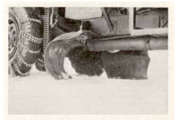
Lumiauraan asennettu raiteenpuhdistaja
