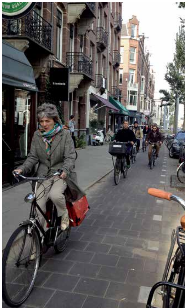
Yksisuuntainen pyöräkaista erotettuna jalankulusta taso- ja materiaalierolla.
