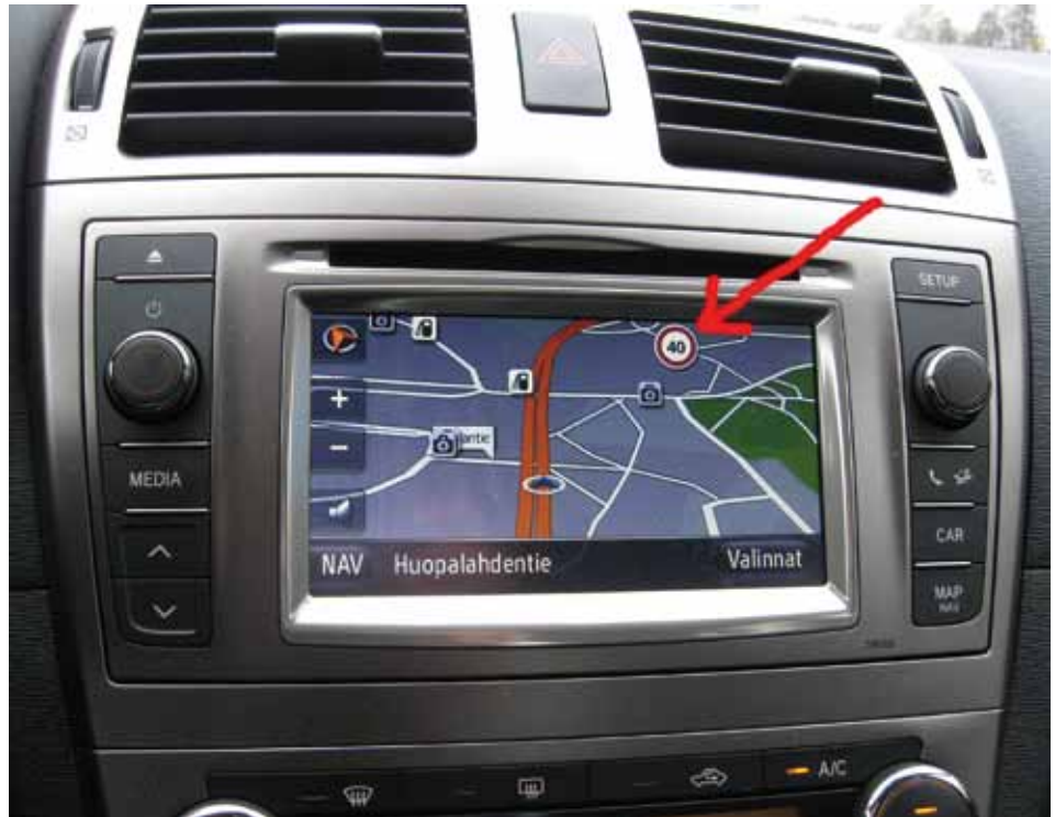
Nykykaaiseen (Toyotan Touch and Go) -navigointijärjestelmään on toteutettu varoittava ISA-järjestelmä.
