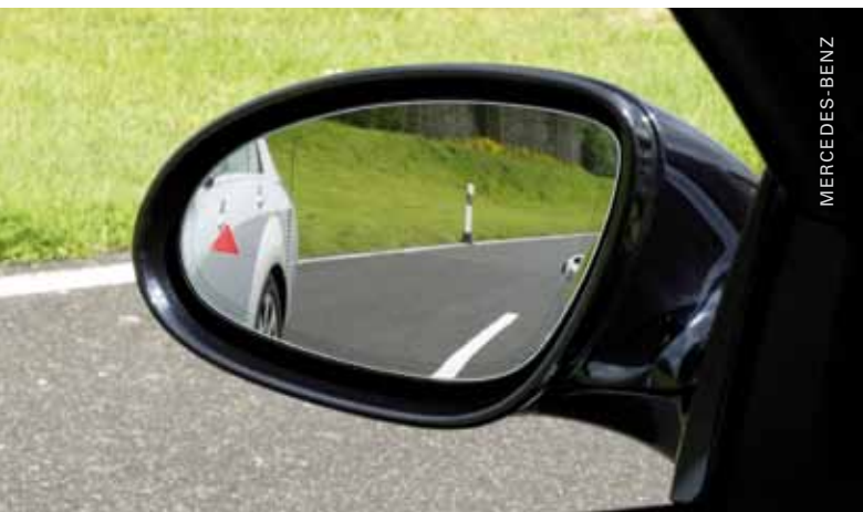
Katveessa olevasta autosta varoitetaan taustapeileissä ole- valla merkkivalolla.
