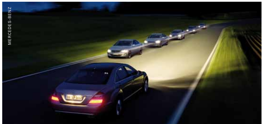
Kehittynyt aktiivinen valojärjestelmä huolehtii siitä, että tietä valaistaan kulloisessakin ajotilanteessa parhaan mahdollisen valotehon antavalla tavalla.
