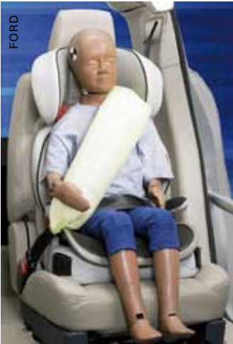
Ford on kehittänyt takaistuintamalla matkustavien turvallisuuden parantamiseksi ilmatyönteisen turvavyön.
