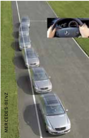
Aktiivinen kaistavahti pyrkii palauttamaan auton takaisin oikealle ajolinjalle.
