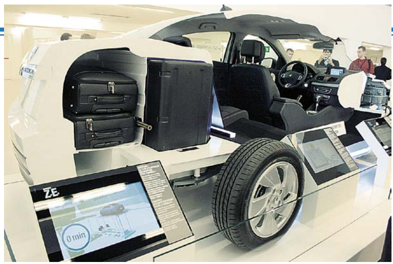
Renaultin osastolla havainnollistettiin miten sähköauton akku vaihdetaan kolmessa minuutissa akkuasemalla.
