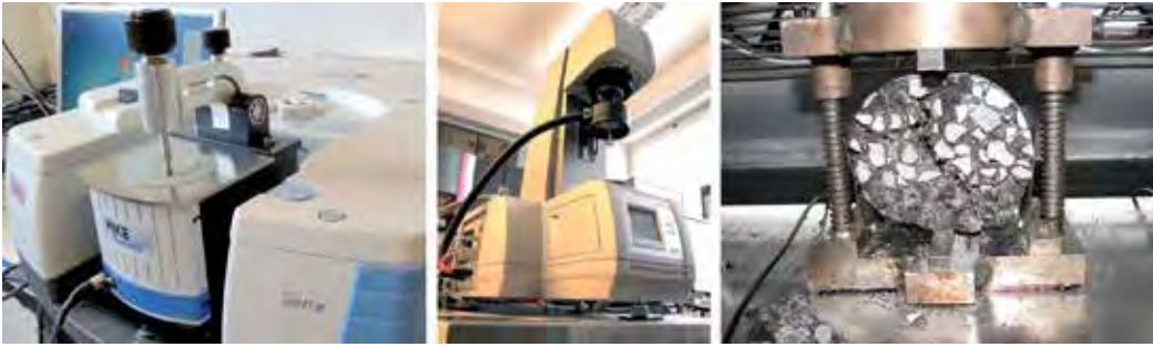
Kuva 2. Vasemmalla hienoaineksen tutkimiseen käytetty FT-IR laitteisto. Keskellä bitumin reologian tutkimiseen käytetty DSR ja oikealla asfalttipäällysteen halkaisuvetolujuuden (HVL) mittausta servo-hydraulisella UTM -laitteella.
