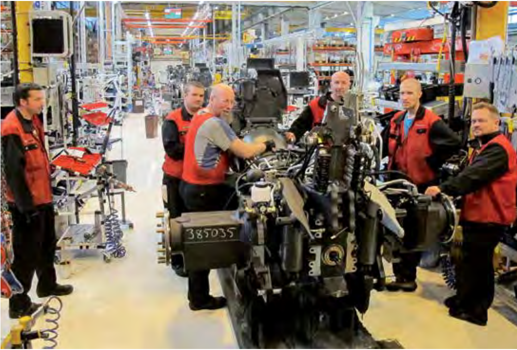
Tästä lähtöpisteestä koneen osat alkavat muokkaantua valmiiksi traktoriksi. Valmis kone tulee ulos 230 metrin kokoonpanolinjan toisessa päässä.
