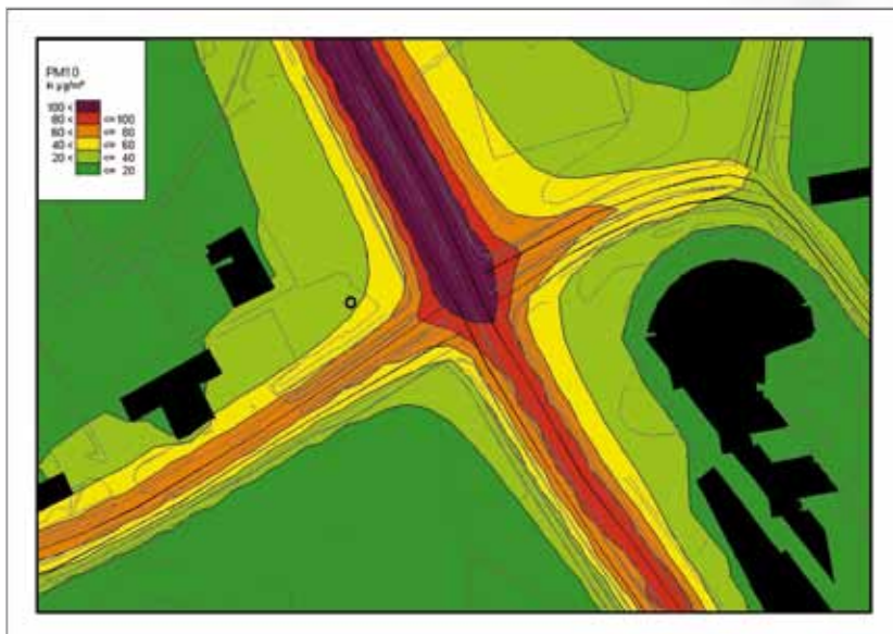
Mallinnusohjelmasta saatava tulokuva, jossa eriväriset vyöhykkeet kuvaavat pitoisuuksia.
