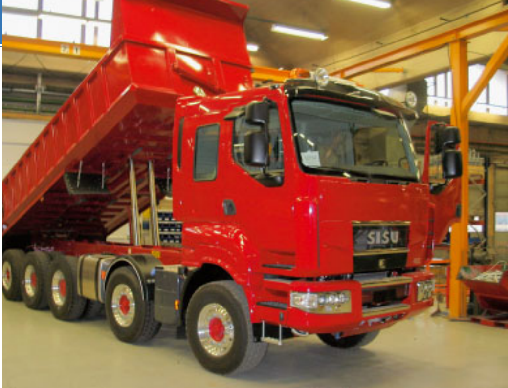
Enemmän tehoa, lisää kantavuutta, useampia akselistoja. Sisujen akselistot valmistaa Sisu Axles Hämeenlinnassa.
