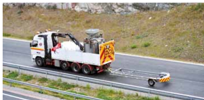
Taaimmainen huoltoauto, jonka perässä törmäysvaimennin.
