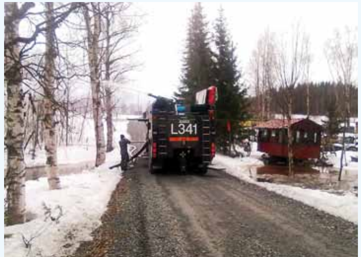
Puolustusvoimien vaahtosammutusauto imee vettä 7 kuutiota minuutissa ja puhalttaa padon ylitse.
