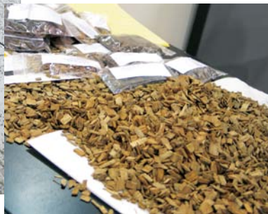
Sveitsiläistä liukkauden torjunta-ainetta; puulastuja ja magnesiumkloridia.
