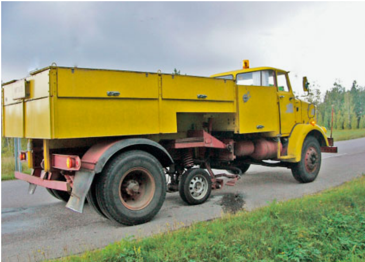
Kuva 1. Kitkanmittausauto Kitka-Sisu (VTT).
