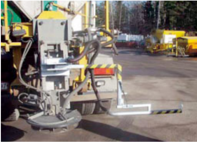
Espoossa kehitetty kalsiumkloridin täsmälevitin. Tekijä Ari Melander, vanhempi hitsaaja, Espoon kaupunki.
