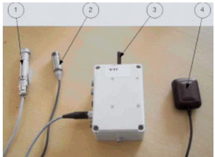
Kuva 2. Kokeessa käytetty mittausmoduuli (VTT, Pekka Kilpeläinen): 1) IR-anturi lämpötilan mittaamiseen, 2) induktiivinen rajakytkin lavan noston rekisteröimiseen, 3) varsinainen mittausmoduuli sisältäen GPRS- ja Flash-OFDM-modeemit, 4) GPS-vastaanotin.
