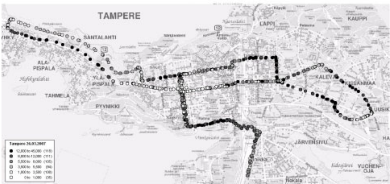
Kuva 1. Nuuskijan mitaamat katupölyn pitoisuudet Tampereella 26.3.2007. Pitoisuusasteikon (vas. albaalla) yksikkönä µg/m 3 . Keskustan kadut ovat subteellisen puhtaita (vaaleat ympyrät), likaisimmat katuosuudet erottuvat tummina.
