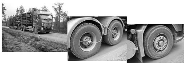
Kuva 1. TPCS-järjestelmä ruotsalaisessa puutavara-ajoneuvossa. (Kuva Svante Johansson)
