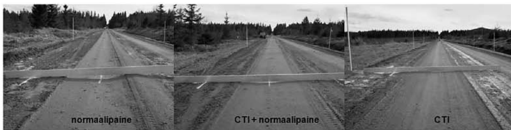
Kuva 5. Esimerkkikuvia soratien urautumisesta Ruotsin CTI-kuromituskokeissa 2005. (Kuva Svante Johansson)
