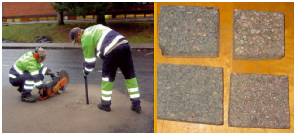
Päällystenäytteitä tien päällä ottamassa (TKK Tietekniikka) ja näytteet valmiina heijastusmittauksiin, yllä ajourasta otettu näyte ja alla ajouran välistä otettu näyte.
