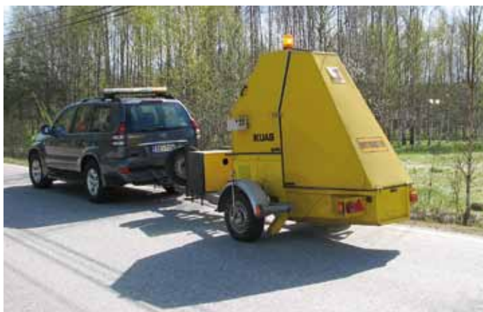
Pudotuspainolaitemittausta Hämeenlinnassa ennen sekoitusjyrsintää.
