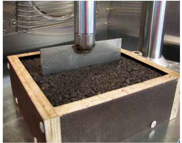
Kuva 2. Työstettävyuden tutkimisessa käytetyn levyvastuskokeen koeasetelma.
