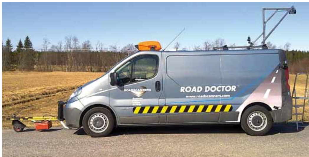
Kuvassa on Roadscanners Oy:n mittausauto. Auton edessä 400 MHz:n maatutka-antenni, katolla etualalla on Road Doctor Cam Link boxi, jonka sisällä ovat video- ja lämpökamerat. Auton takaosassa korkealla on laserskanneri.
