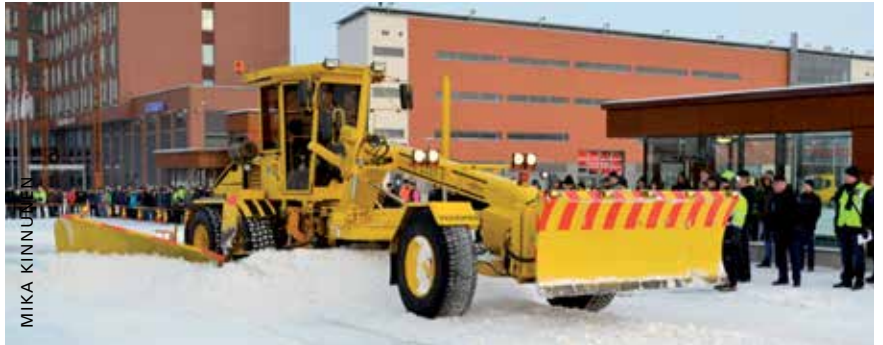
Veekmas Oy:n tiehöylä FG 2327 S, puskulevyn, lumistopparin ja sivuauran kanssa, diplomi.
