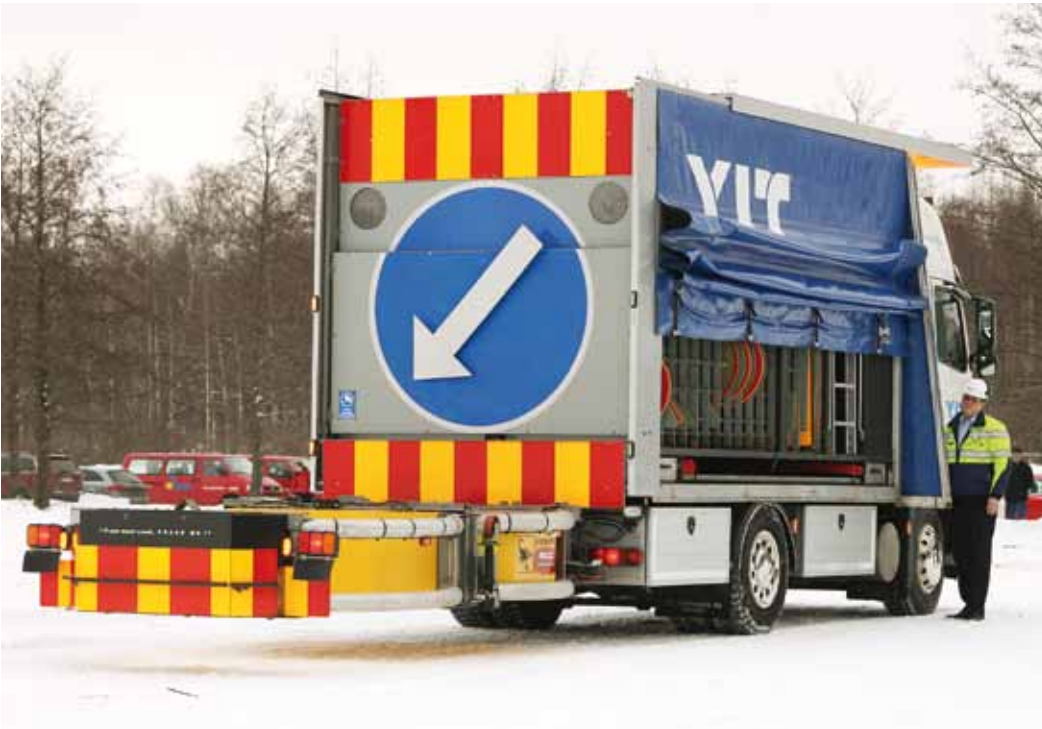
YIT:n törmäysvaimentimella varustettu liikenteenohjausyksikkö.
