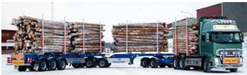
Kokeiluauto Ruotsin "En Trave TIII" –projektissa, pituus 30 m, kokonaispaino 90 t, 11 akselia. (Lähde: Skogforsk)
