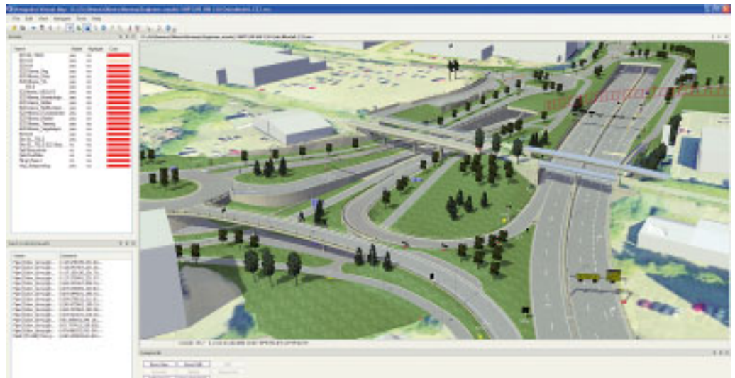
HW150 Oslo koordinointimalli havainnollistaa hyvin monimutkaiset tiejärjestelyt ja useassa tasossa kulkevan tunnelijärjestelmän. Auringonvalosimulaatio 1.8.2009 klo 13:00.
