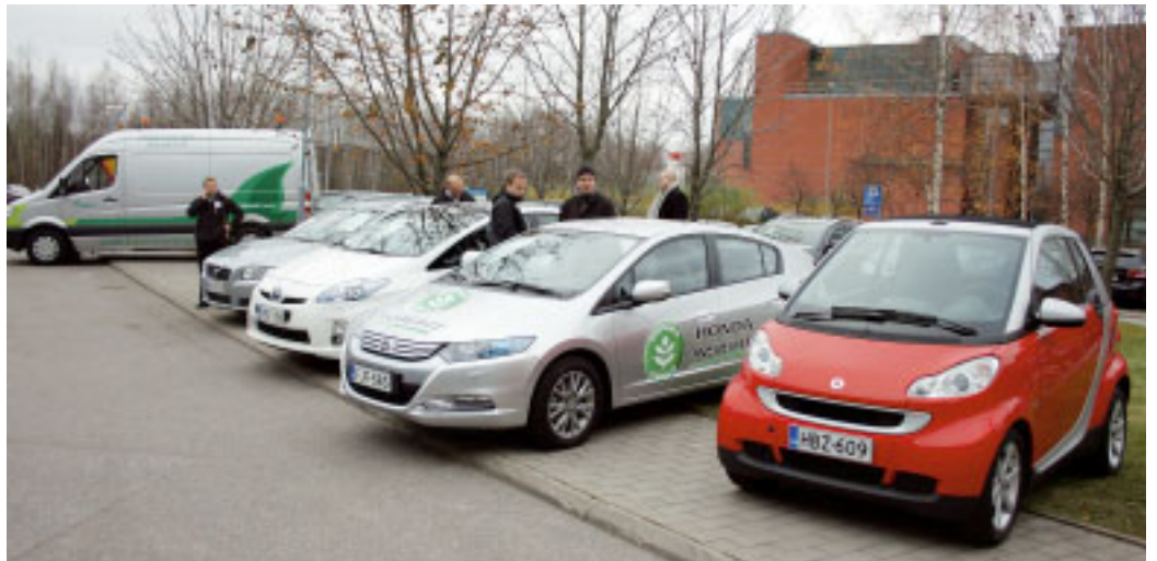
Smart Micro Hybrid, Honda Insight ja Toyota Prius (2010 malli) ovat bensiini/hybridiautoja, joiden CO2 päästöt vaihtelevat välillä 89-105 g/km. Volvo V50 Drive kulkee dieselillä ja CO2 päästö on 104 g/km. Takana MB Sprinter pakettiauto, joka kulkee biokaasulla ja päästää CO2:ta 245-260 g/km.
