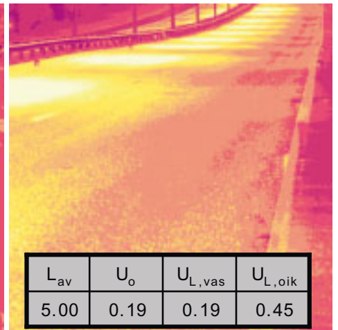
Tien pinnan luminanssijakauma kun tien pinta on kuiva (talvella), vähäluminen sekä märkä. Keskimääräinen luminanssi L_{av} , yleistasaisuus U_o ja pitkittäistasaisuudet U_L molempien ajokaistojen keskilinjalta.
