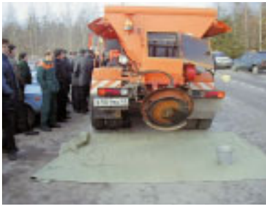
Vanhemman venäläisen levittimen kalibrointi menossa. (Kuva Jubani Valjakka)
