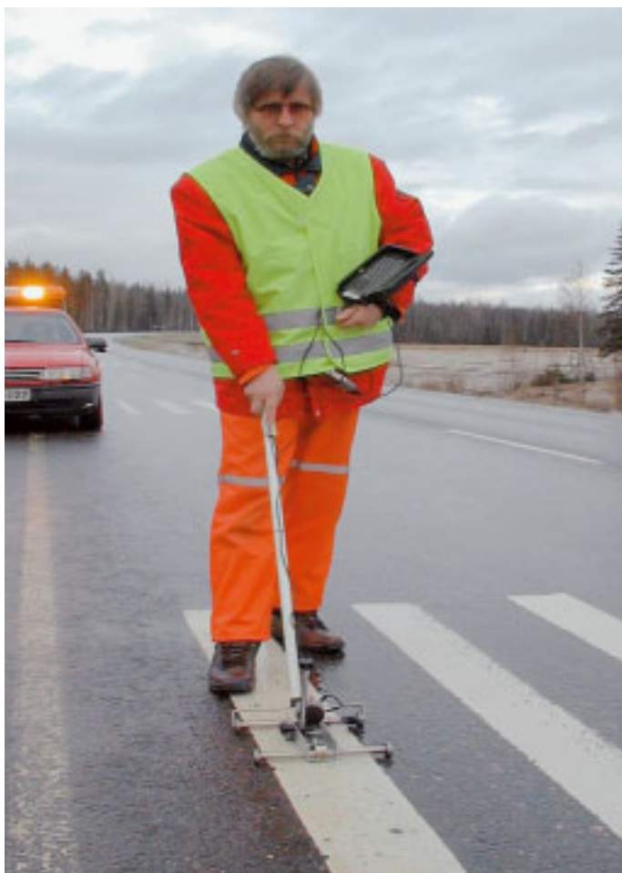
Timo Unbola mittaa merkinnän paksuutta kebittämälään paksuusmittarilla.
