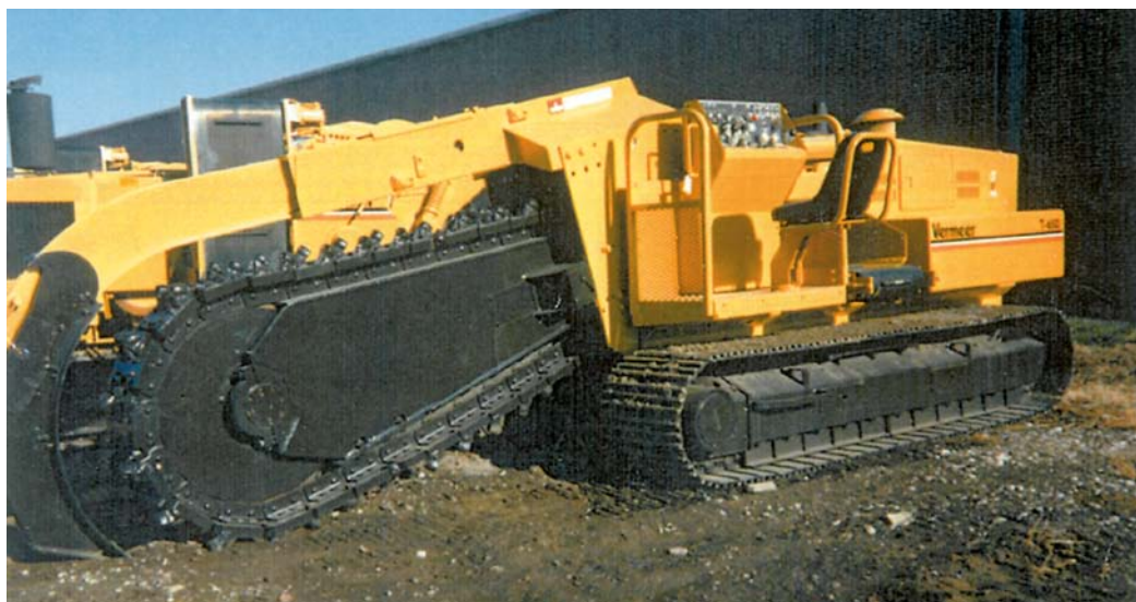
Salaojituskone, jolla päästään noin kahden metrin syvyyteen.
