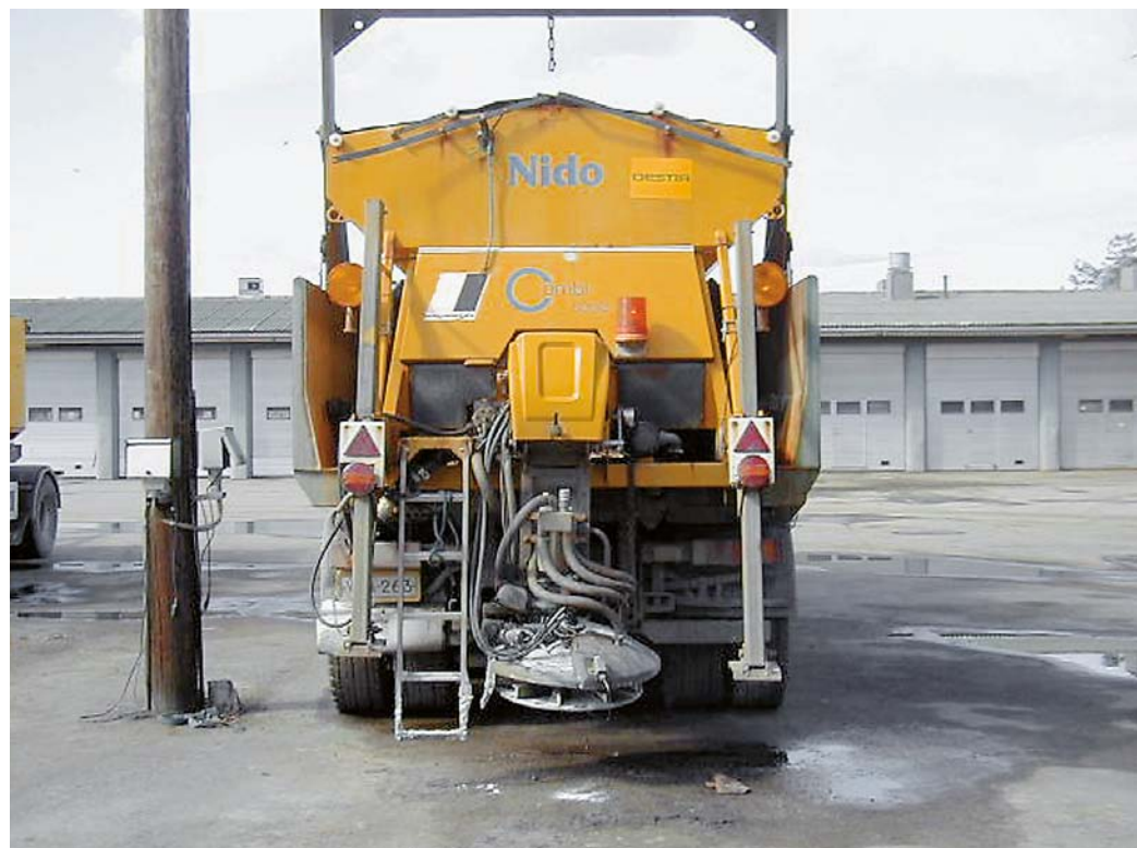
Suolausauto. Autossa on kaksi säiliötä, jolloin samalla ajoneuvolla voidaan levittää sekä kaliumformiaattia että natriumkloridia eri suolauskäytäntöalueilla eikä auton tai säiliön vaihtamista suolausalueen rajalla tarvita. Kuva Juhani Valjakka
