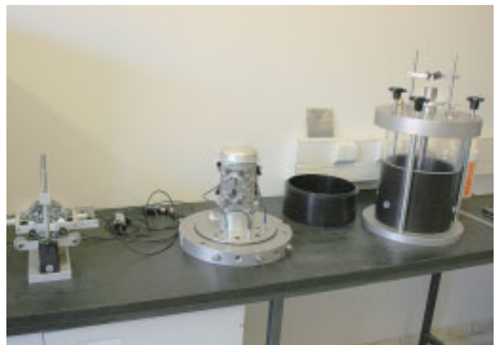
Lisälaitteilla testausmahdollisuudet laajenevat. Vasemmanpuoleisen laitteen avulla voidaan testata jäännösmoduulia tai balkaisuvetolujuutta. Näytteen instrumentointi on tarkkaa puubaa, sillä näytteeseen liimattavien nappien asentamiseen käytetään automaattista kiinnityslaitetta, jotta napit tulevat juuri oikeaan asentoon. Oikealla geotekninen selli.
