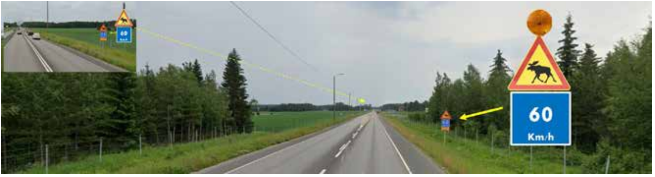
Aktiivinen hirvivaroitussysteemi ennen riista-aidan aukkoaluetta. Keltainen varoitusvalkko ja Hirviä varoitussysteeminmerkki.
