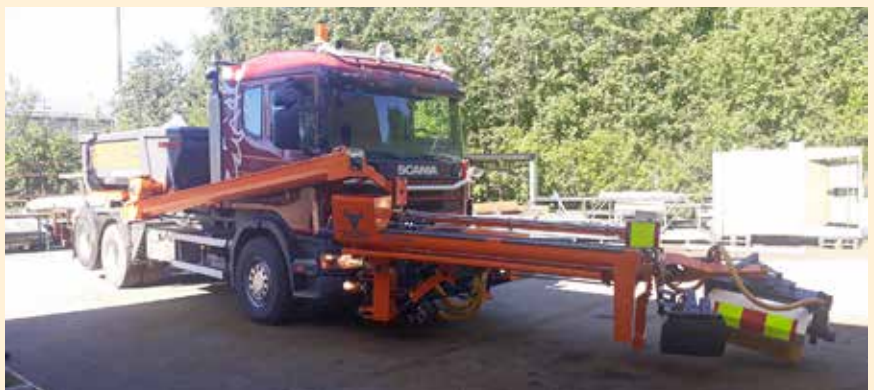
OXSA ARM 4000 on kuorma-auton vaihtolavalle rakennettu asfaltinpaikkauskone.
