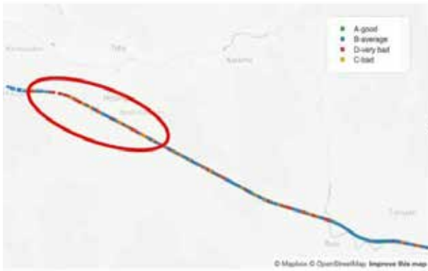
Joukkoistetuista mittauksista saatu kuva tien huonojen kohtien sijoittumisesta vt 3:lla. Kuva: Road Cloud Oy.
