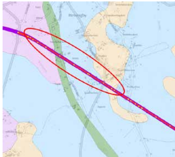
Joukkoistetuista mittauksista saatu kuva tien huonojen kohtien sijoittumisesta vt 3:lla. Kuva: Road Cloud Oy.
